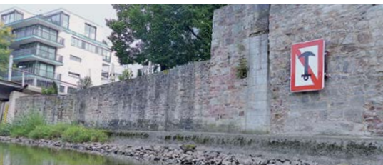
Schiffahrtszeichen „A.6“: Ankerverbot u. Verbot des Schleifenlassens von Ankern, Trossen o. Ketten auf der Seite der Wasserstraße, auf der das Tafelzeichen steht.
